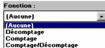
Les compteurs / décompteurs intégrés aux bases de TSX MICRO se trouvent dans le **module 00, voie 11** pour le 1<sup>er</sup> compteur, **voie 12** pour le 2<sup>em</sup> compteur.
